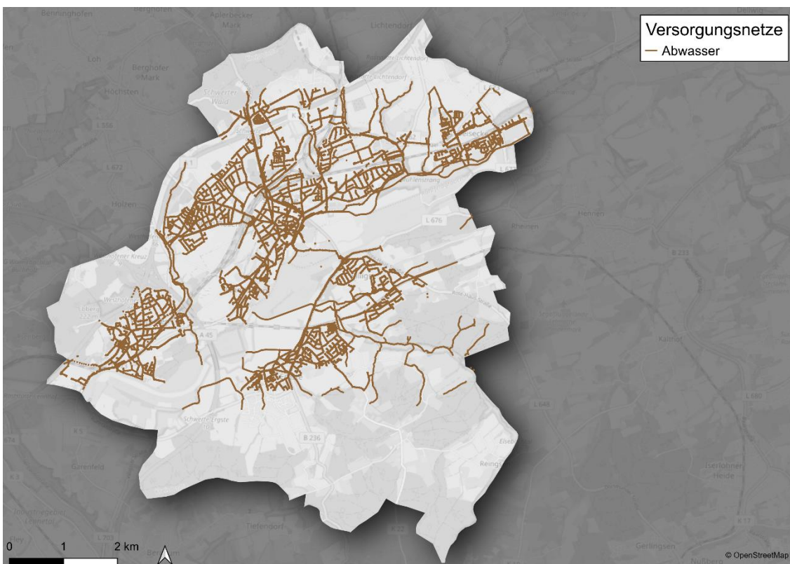
Abbildung 28: Abwassernetze mit Mindestnenngroße DN800
