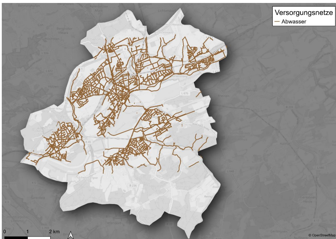
Abbildung 28: Abwassernetze mit Mindestnenngroße DN800
